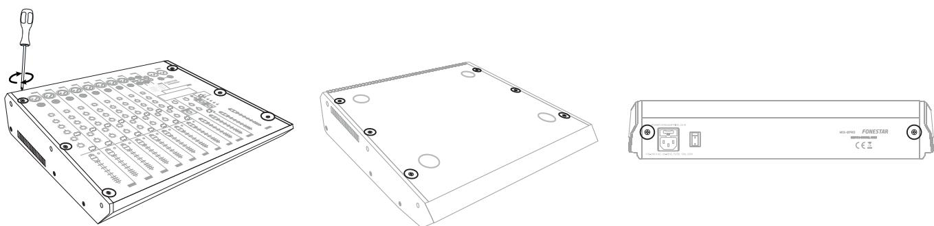
4.- Montez les supports SM-8PRO sur la table de mixage avec les vis fournies avec la table de mixage.
